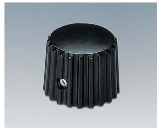
A1321160 Регулировочная ручка с боковым монтажным винтом АБС (UL 94 HB) черный RAL 9005 20x16mm 6mm
