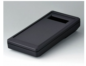
A9075219 DATEC-MOBIL-BOX L, исп. II АБС (UL 94 HB) черный RAL 9005 252x121x50mm IP 65 opt.
