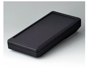
A9075119 DATEC-MOBIL-BOX L, исп. I АБС (UL 94 HB) черный RAL 9005 252x121x50mm IP 65 opt.
