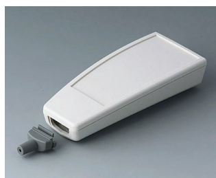
A9067147 SMART-CASE L, исп. V АБС (UL 94 HB) белый RAL 9002 140x62,7x30,5mm IP 65 opt., IP 40
