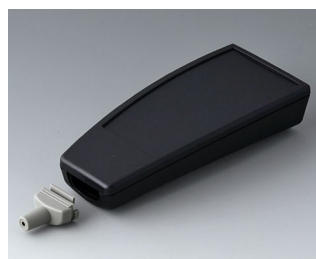
A9067149 SMART-CASE L, исп. V АБС (UL 94 HB) черный RAL 9005 140x62,7x30,5mm IP 65 opt., IP 40
