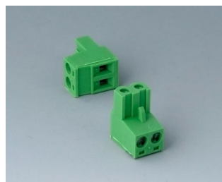
V6606223 Розеточная часть соединителя, шаг 5,08 мм ПА 6 (UL 94 V-0)
