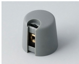
A1016048 Ручка TOP-KNOB 16 ПА 6 вулкан 16x16mm 4mm
