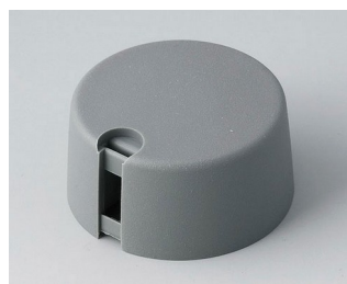
A1031048 Ручка TOP-KNOB 31 ПА 6 вулкан 31x16mm 4mm
