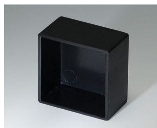
A8021129 POTTING BOX, исп. III АБС (UL 94 HB) черный RAL 9005 21,2x21,2x12,1mm
