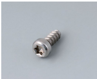
A0325060 Шуруп 2,5 x 6 мм (T8) нержавеющая сталь
