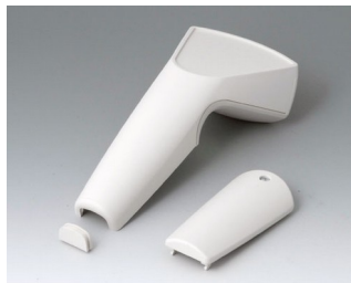
A9056107 SENSO-CASE M АБС (UL 94 HB) белый RAL 9002 180x86x45mm IP 41
