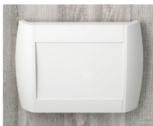
A9094107 DIATEC M АБС (UL 94 HB) белый RAL 9002 270x48x200mm IP 40
