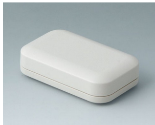
A9401107 EVOTEC 80, исп. I АСА+ПК (UL 94 V-0) белый RAL 9002 80x50x22mm IP 65 opt., IP 40
