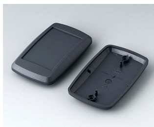
B9006808 Верхняя и нижняя части EL АБС (UL 94 HB) лава 78x48x24mm
