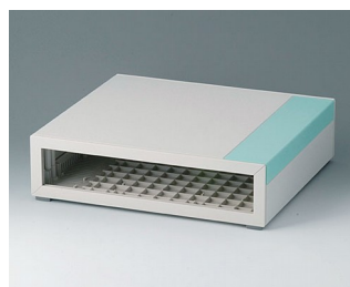
B2210015 MEDITEC D 220, без ручки АБС (UL 94 HB) белый RAL 9002 290x260x74mm IP 40
