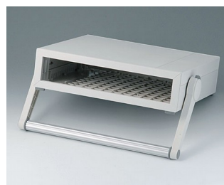
B2210117 MEDITEC D 220, с ручкой АБС (UL 94 HB) белый RAL 9002 290x260x74mm IP 40
