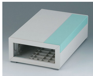
B2212015 MEDITEC E 220, без ручки АБС (UL 94 HB) белый RAL 9002 160x260x74mm IP 40
