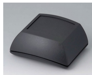
B7005109 ERGO-CASE S, высокий АБС (UL 94 HB) черный RAL 9005 80x96x44mm IP 54 opt.
