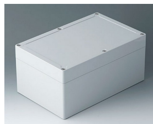
C7025091 IN-BOX АБС (UL 94 HB) светло-серый RAL 7035 252x162x120mm IP 66, IP 67, IK 07
