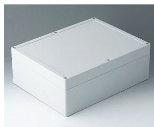
C7030111 IN-BOX АБС (UL 94 HB) светло-серый RAL 7035 302x232x110mm IP 66, IP 67, IK 07
