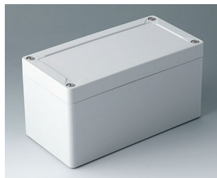
C7016021 IN-BOX АБС (UL 94 HB) светло-серый RAL 7035 162x82x85mm IP 66, IP 67, IK 07
