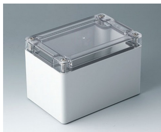
C7012024 IN-BOX АБС/ПК (UL 94 HB) светло-серый RAL 7035 122x82x85mm IP 66, IP 67, IK 07
