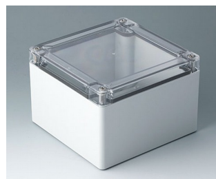
C7013054 IN-BOX АБС/ПК (UL 94 HB) светло-серый RAL 7035 124x122x85mm IP 66, IP 67, IK 07
