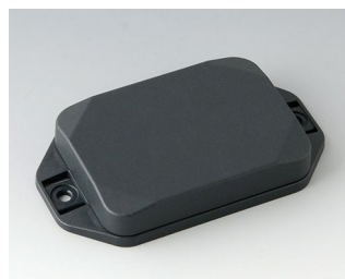
B1824128 MINI-DATA-BOX EF50, плоский, с ушками АСА+ПК (UL 94 V-0) тёмно-серый RAL 7016 70x50x15mm IP 65 opt., IP 40
