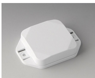
V1804127 MINI-DATA-BOX SF50, плоский, с ушками АСА+ПК (UL 94 V-0) белый RAL 9016 50x50x15mm IP 65 opt., IP 40
