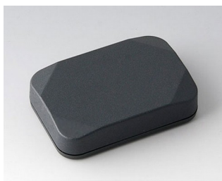
V1822118 MINI-DATA-BOX E40, плоский АСА+ПК (UL 94 V-0) тёмно-серый RAL 7016 60x40x15mm IP 65 opt., IP 40
