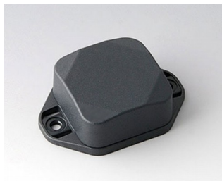
V1802228 MINI-DATA-BOX SF40, высокий, с ушками АСА+ПК (UL 94 V-0) тёмно-серый RAL 7016 40x40x20mm IP 65 opt., IP 40
