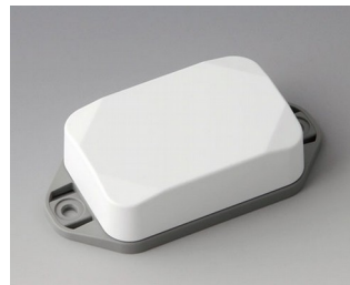
V1822226 MINI-DATA-BOX EF40, высокий, с ушками АСА+ПК (UL 94 V-0) белый RAL 9016 60x40x20mm IP 65 opt., IP 40
