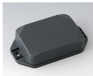
V1824228 MINI-DATA-BOX EF50, высокий, с ушками АСА+ПК (UL 94 V-0) тёмно-серый RAL 7016 70x50x20mm IP 65 opt., IP 40
