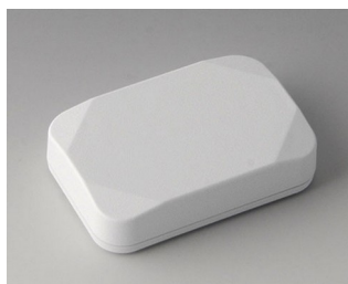
V1822117 MINI-DATA-BOX E40, плоский АСА+ПК (UL 94 V-0) белый RAL 9016 60x40x15mm IP 65 opt., IP 40
