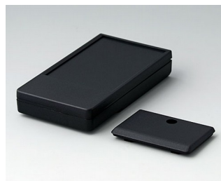
A9071209 DATEC-POCKET-BOX M ПММА (ИК) (UL 94 HB) черный RAL 9005 105x58x18,5mm IP 41
