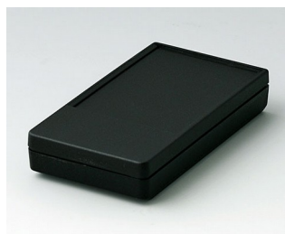
A9070219 DATEC-POCKET-BOX S ПММА (ИК) (UL 94 HB) черный RAL 9005 85x46x16mm IP 54
