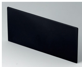
B6143221 Лицевая панель ПФО (UL 94 V-0) черный RAL 9005 139,3x67,5x2mm
