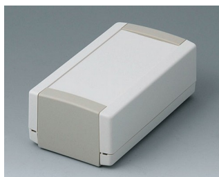
V1050365 TOPTEC 123 H, исп. I АБС (UL 94 HB) белый RAL 9002 123x68x45mm IP 40
