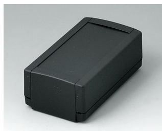
V1050369 TOPTEC 123 H, исп. I АБС (UL 94 HB) черный RAL 9005 123x68x45mm IP 40
