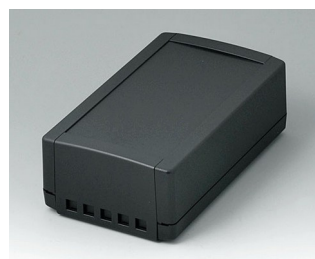
B1070469 TOPTEC 194 H, исп. II АБС (UL 94 HB) черный RAL 9005 194x115x68mm IP 40
