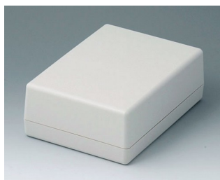
A9413341 SHELL-TYPE CASE G 190, исп. I АБС (UL 94 HB) белый RAL 9002 138x190x68mm IP 65 opt.
