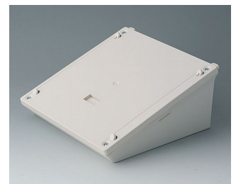
B4046837 База L для подзарядки и хранения АБС (UL 94 HB) белый RAL 9002 183x183x80mm
