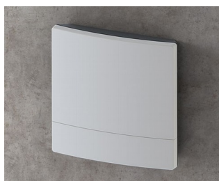
B3222101 NET-BOX 220, исп. I АСА+ПК (UL 94 V-0) светло-серый RAL 7035 220x220x50,5mm IP 65 opt., IP 40
